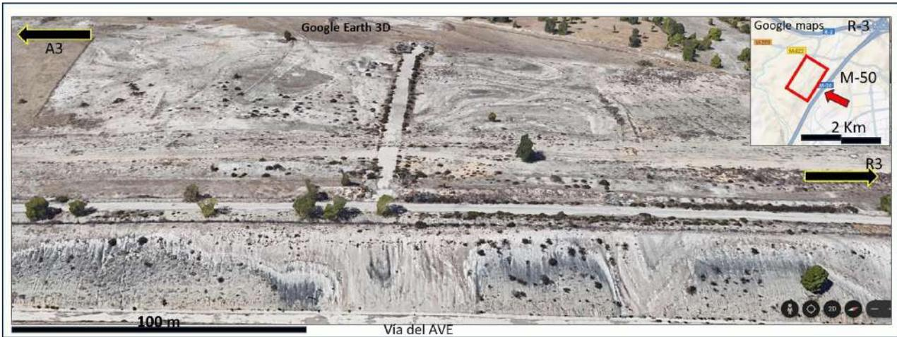
FIGURA 5. Deformaciones tipo “soft-sediments” (Giraldo, 2023) en capas miocenas (entre autovías A-3 y R-3). El talud sub-vertical corresponde a la vía del AVE. Se indican coordenadas geográficas en la parte central del talud: 40°22'49"N y 3°33'13"W. Observe las trazas de las capas en el terreno (Fig. 6 para detalles de la vista en planta).
